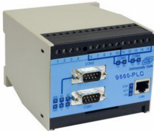
Dimensions : 75 x 100 x 116 mm. DIN Rail Module
